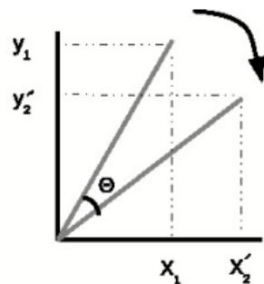
$$\begin{bmatrix} \cos(\theta) & \sin(\theta) \\ -\sin(\theta)^* & \cos(\theta) \end{bmatrix} \begin{bmatrix} x_1 \\ y_1 \end{bmatrix} = \begin{bmatrix} x'_2 \\ y'_2 \end{bmatrix}$$
